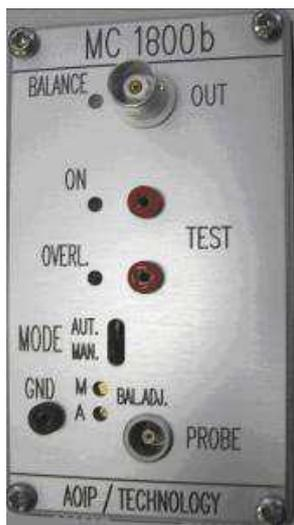
このユニットはプローブ毎に校正されており、その出力はデジタル化ユニットに接続できます。通常、モジュールは試験室内にあり、DC電源が供給されています。一般的な計量機能はMC 1000と同様です。サイズ(mm)は220×140×70です。
