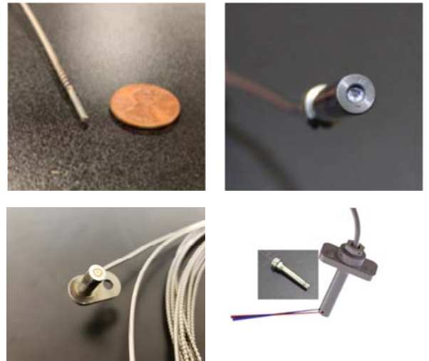
左上：レンズ無し プローブ 右上：レンズ付き プローブ 左下：90 度角 プローブ 右下：潜望鏡型 プローブ
